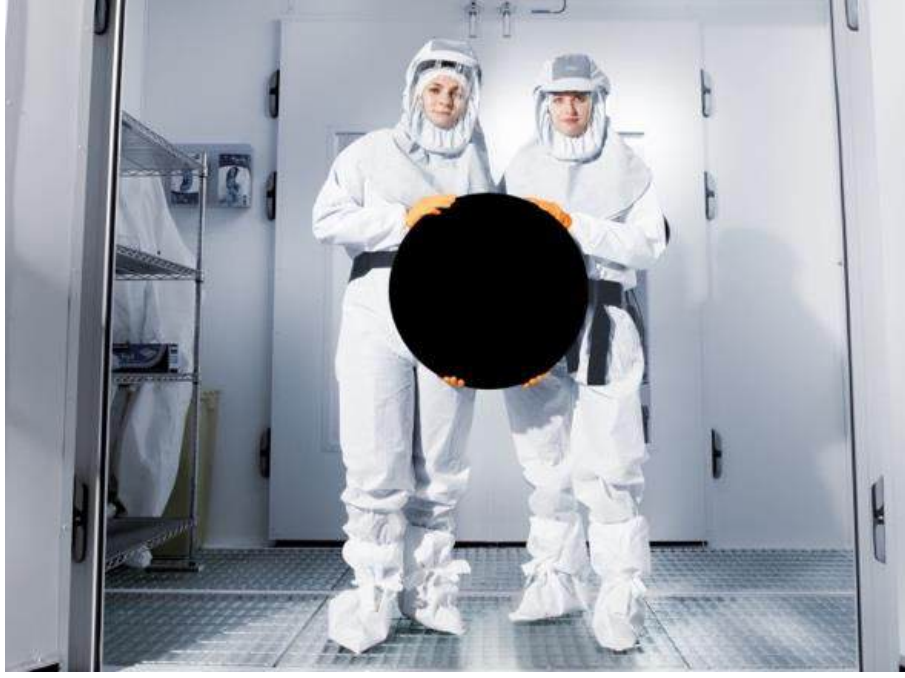
Resim 1. Surrey Nano Systems'den iki geliştirici hacmi anlaşılamayan Vantablack kaplı nesneyi göstermekte
