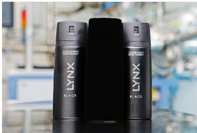
Resim 2. Surrey Nano Systems'den iki geliştirici hacmi anlaşılabilen Vantablack kaplı nesneyi göstermekte.
